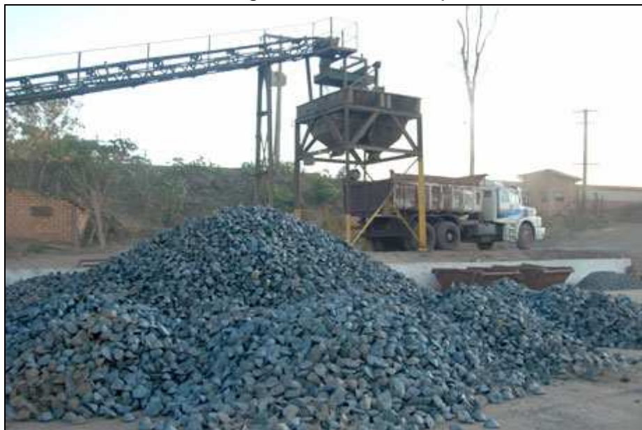
Foto 1: Pelotas de ferro gusa estocadas no pátio de uma siderúrgica.
